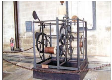
saatin dizayni və işləmə prinsipi eserlərde deyisməz qalıb. Eyni mexanizmdə kilselerin və içtimai binaların qülələrində yerləşdirilən saatlar üçün de istifadə olunur.
