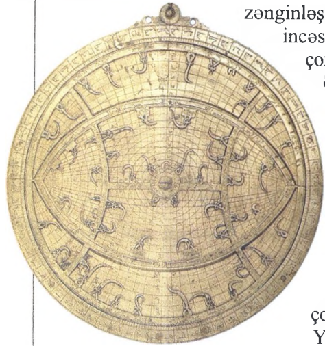
Ərəb astrolyabiyası. Astrolyabiya – astronomiyada enlik və uzunluqları təyin etmək üçün istifadə edilən qədim bucaqölçən alət.
