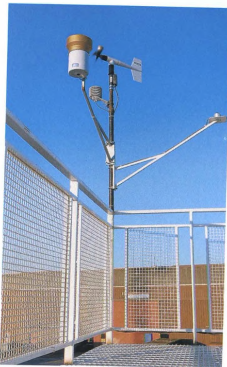
Gəmidə quraşdırılmış meteoroloji müşahidə cihazları.
