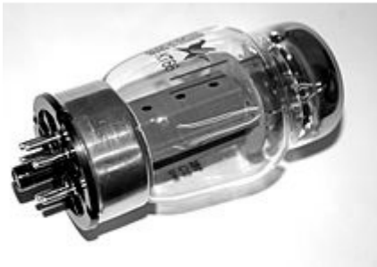
Şəkil 224. Şüalı tetrodun quruluşu və şərti işarəsi
