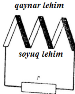
Şəkil 55. Termoelektrik generatorun sadə sxemi
