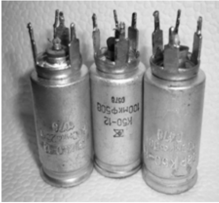
Şəkil 11. Elektrolit kondensatorlar: alüminium stəkanlar; 2- kontaktlar
