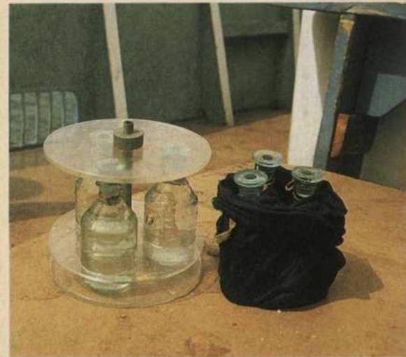
Fitoplankton məhsulunu müəyyənləşdirmək üçün istifadə olunan tünd və şəffaf şüşə qablar.
