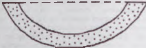
Şəkil 2.8. Pyezometrik səthi üfüqi olan lay.
