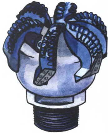
Müxtəlif bərklikdə olan süxurlarda işləmək üçün almaz örtüklü balta növləri
