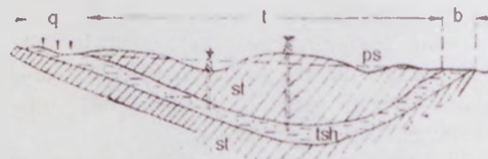
q - qidalanma sahəsi; t - təzyiqli yaranma zonası b - boşalma sahəsi; tsh - təzyiqli su horizontu, st - sukeçirməyən təbəqə, ps - peyzometrik səviyyə.
