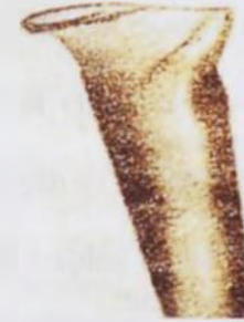
Şəkil 35. Burulmadan yaranan qırılma
