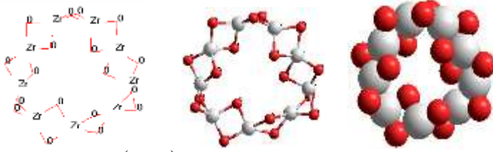
Şəkil 12.32. (ZrO_2)_9 nanohissəciyinin xətt, kürə-silindir və kürələrlə modeli
