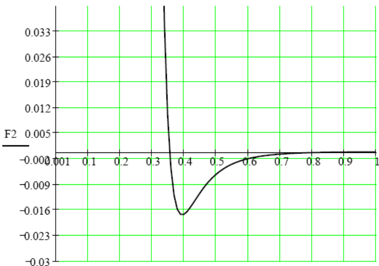
Şəkil 8.2. Atomlar aras y qarşılıqlı təsir F qüvvəsinin atomlar aras y R məsafəsindən asılılıq qrafiki
