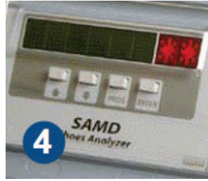
Şəkil 3.9. Ayaqqabı metaldetektorunun istifadə qaydaları: 1 - SAMĐ elektron blokunda PLACE FOOT xəbərdarlığı əks olunur; 2 – OK - onu göstərir ki, baxış keçirilmiş, metal əşya aşkar olunmamışdır; 3 – REMOVE - sərnəşinə baxışın başa çatdığını bildirir; 4 - Təhlükəli əşya aşkar olunduqda, səs və vizual həyəcan signalı verilir
