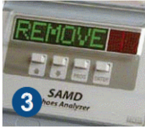
Şəkil 3.9. Ayaqqabı metaldetektorunun istifadə qaydaları: 1 - SAMĐ elektron blokunda PLACE FOOT xəbərdarlığı əks olunur; 2 – OK - onu göstərir ki, baxış keçirilmiş, metal əşya aşkar olunmamışdır; 3 – REMOVE - sərnəşinə baxışın başa çatdığını bildirir; 4 - Təhlükəli əşya aşkar olunduqda, səs və vizual həyəcan signalı verilir
