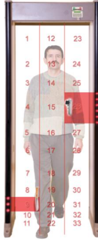
Şəkil 3.5. Üzərində metal əşya olan şəxsin metal detektordan keçməsi zamanı xəbərdarlıq siqnallarının yaranması
