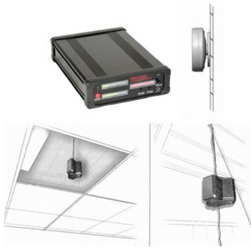
Şəkil 6.14. Küy generatoru
