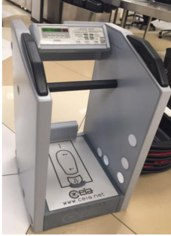
Şəkil 3.8. Ayaqqabı metaldetektoru
