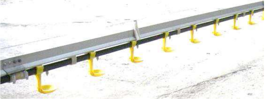
Şəkil 12. Quşların qrup şəklində qalın döşənək üzərində saxlanması zamanı suvarılmasında istifadə olunan Nipelli su qablarının görünüşü
