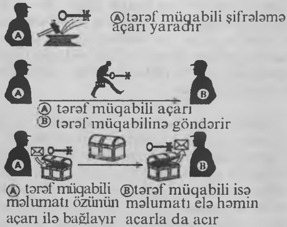
Şəkil 3.1. Simmetrik açarla məlumatın qorunması
