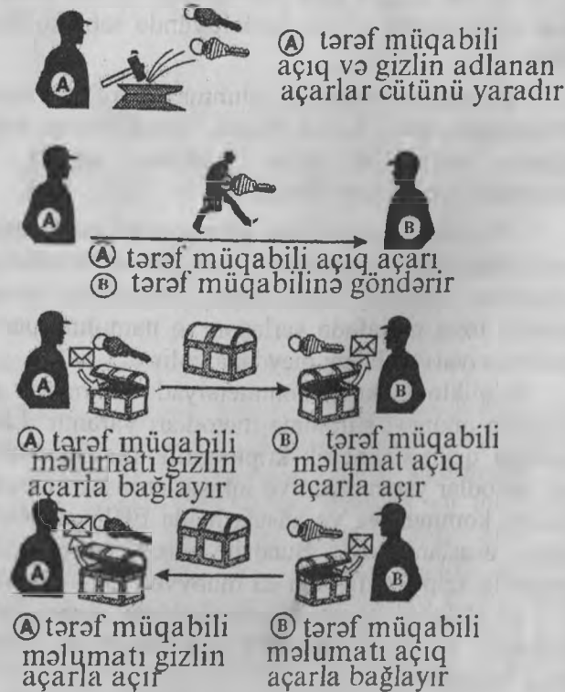
Şəkil 3.2. Məlumatın qeyri-simmetrik açarlarla qorunması
