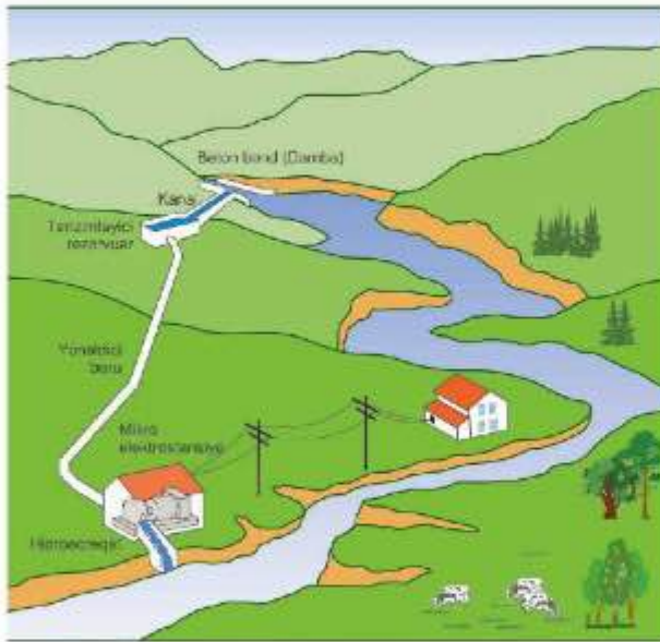
Şəkil 4.33. Kiçik hidroenergetik sistemin iş prinsipi
