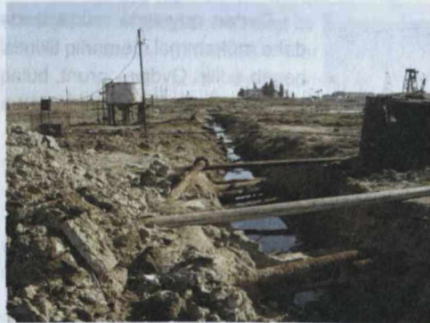
13-cü foto. Köhnə mädəndə neft durulducu çala. Suyun buraxılması prosesi.
