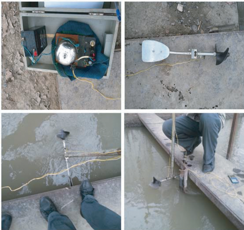
Şək. 6.1. GP -21M hidrometrik fırlanğıcla axın ölçmələri, Salyan , 2013
