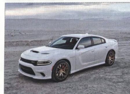
Dodge Charger SRT Hellcat minic avtomobil [2016, mühərrikinin işlək həcmi – 6,2 l, gücü – 530 kVt (717 a.q.) maks. sürəti – 329 km/saat].
