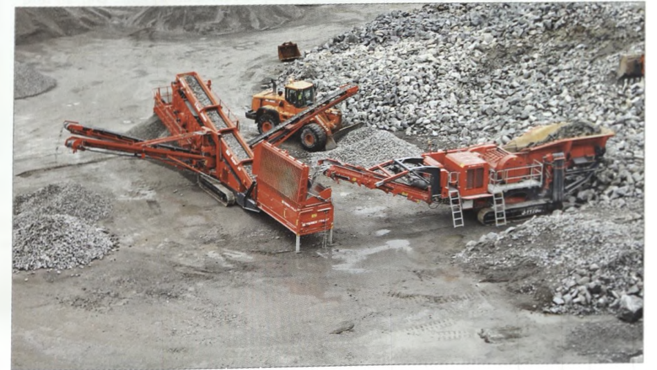
TEREX FINLAY J-1170 doğrama-çəşidləmə qurğusu (Şm. İrlandiya).
