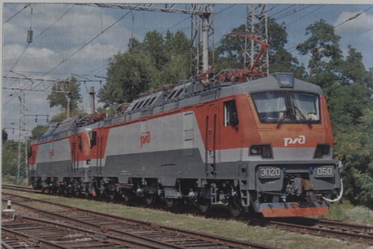
6 oxlu sürətli ЭП20 səmişin elektrovozu. "Transmaşxoldinq" (RF) və "Alstom Transport" (Fransa).
