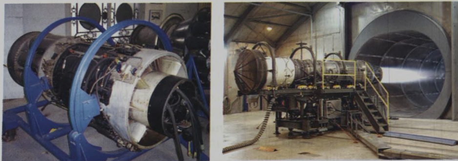
Aviasiya mühərriki: a) ilk kompressorlu turboreaktiv mühərrik – "General Elektrik J47"; b) F100-PW220 turboreaktiv mühərriki.
