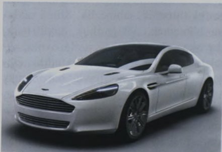
Aston Martin Rapide minik avtomobili [ili 2010; mühərrikinin işlək həcmi 6,0 l; gücü 350 kVt (477 a.q.); maks. sürəti 303 km/saat].
