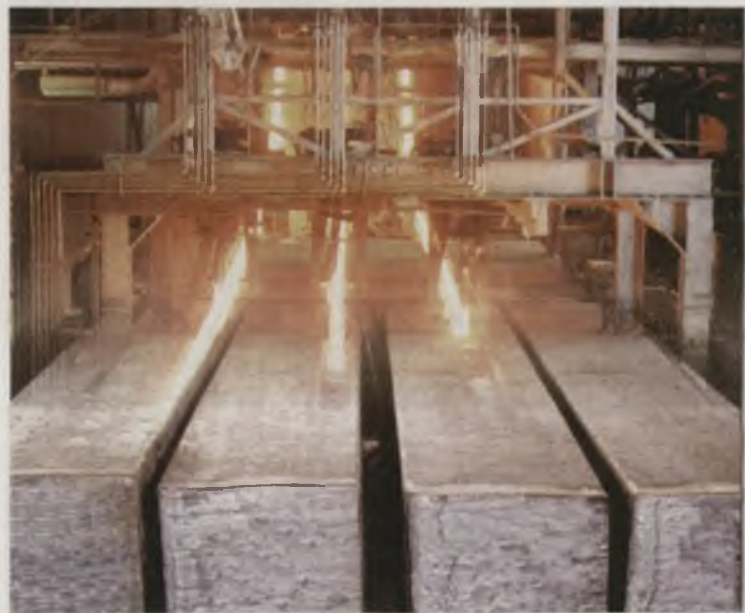
"Bakı Polad İstehsalat Şirkəti" (Baku Steel Company). Tökmə maşınlarında istehsal olunan polad pastahlar.
