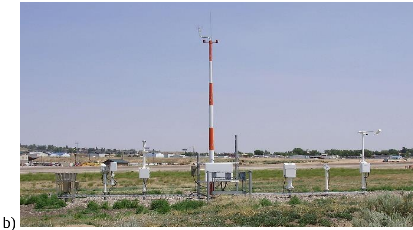
Şəkil 2.7. Ənənəvi (a) və avtomatlaşdırılmış (b) hidrometeoroloji stansiyalar
