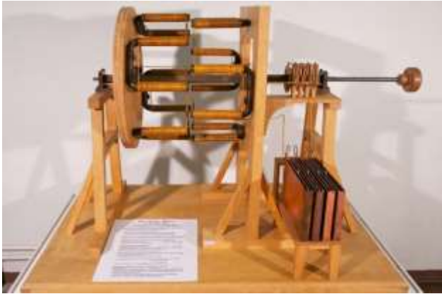
Şəkil. Yakobinin hazırladığı elektrik mühərriki
